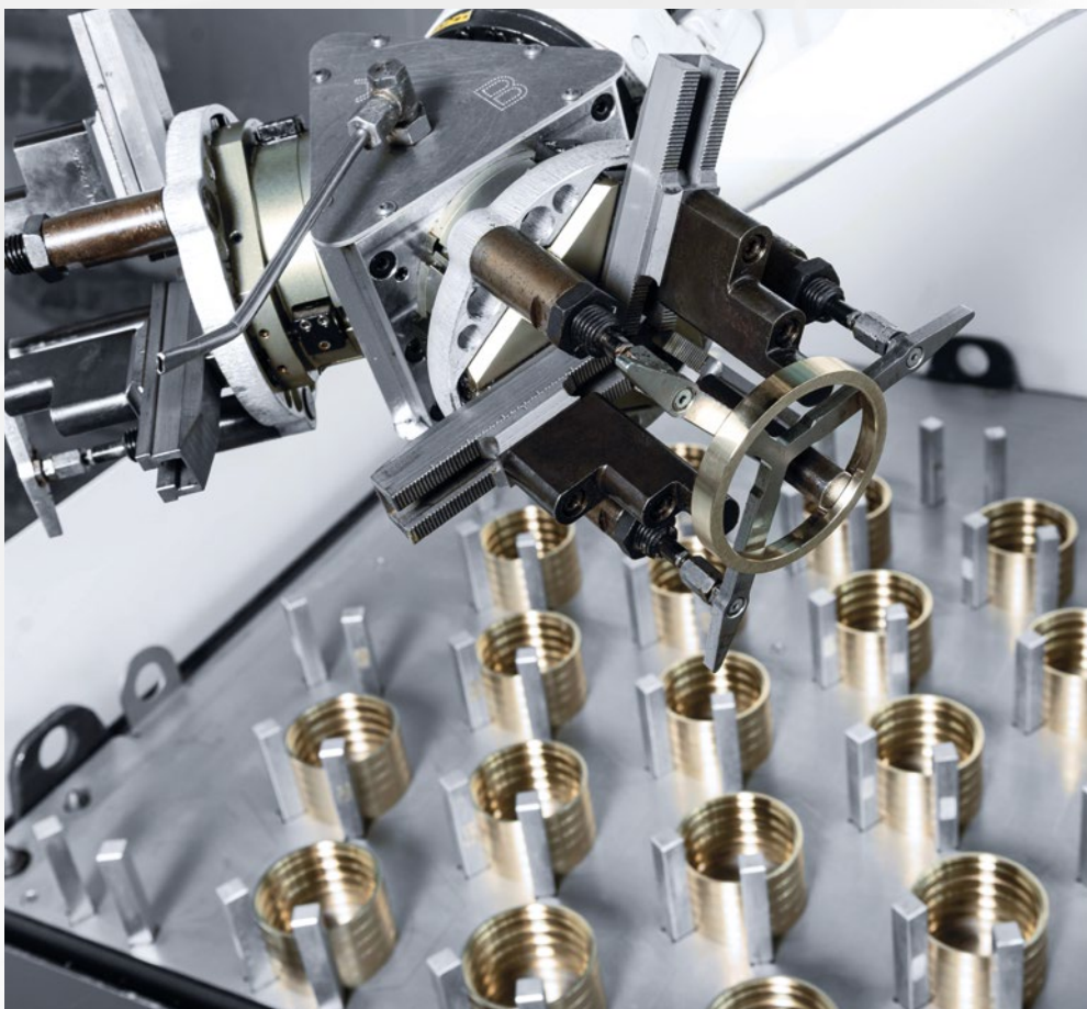
Das Stapelmagazin des Robo2Go bietet ausreichend Platz, sodass auf der CTX beta 800 TC rund um die Uhr produziert werden kann.
